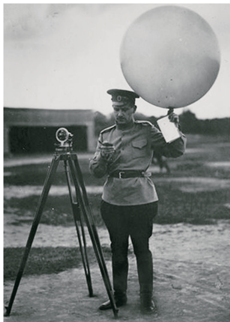
Запуск шаропилота для определения высоты облаков, скорости и направления ветра.
